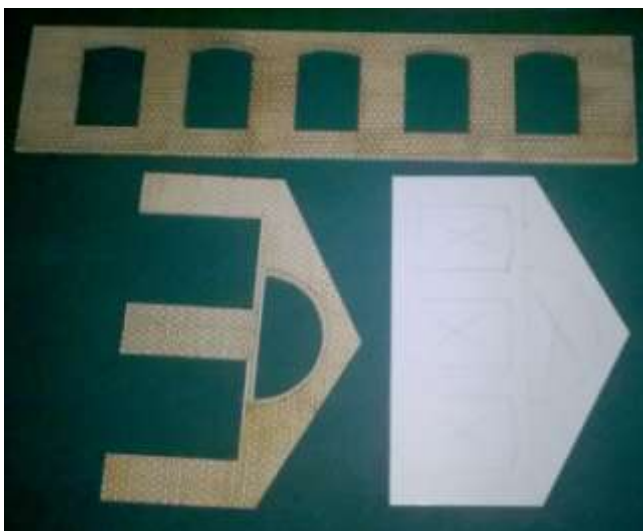
Exemple de gravure de briques sur forex de 3 mm d'épaisseur pour une remise à locomotive à deux voies en cours de construction pour le réseau du club
