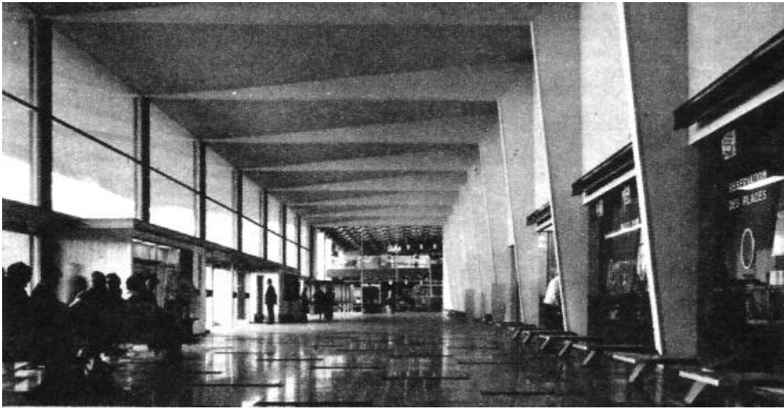
Salle des guichets : nervure voile en béton de silex blanc bouchardé. Dans le fond la brasserie et le restaurant.
