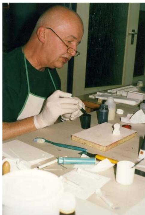
A l'occasion d'une rectification ou d'une réparation de moule, on peut préparer une petite quantité de silicone à durcissage rapide (50 % de durcisseur). Mais les
