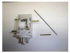
05 Remonter le couvercle, couper un morceau de corde à piano de dia.2mm, longueur 100mm, quelques morceaux de tube laiton
