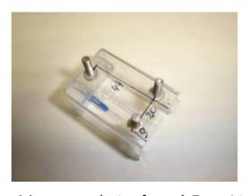
04 A ces endroits forer à 5mm. Limer la tête des vis à 1 mm d'épaisseur Coller par l'intérieur (cyano) 3 vis de M5 x15mm
