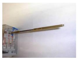
08 Coller 10 mm de tube laiton, enfiler un morceau de 30 mm (libre), fermer avec un tout petit bout de tube 2/2,5mm
