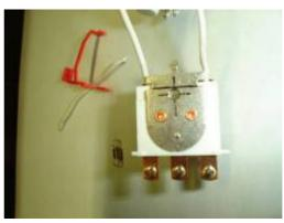
02 Ouvrir me relais (cure-dents et petit tournevis) éliminer le contact central et forer ici (à la main)un trou de 3mm.
