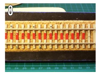
Cette fixation terminée, les clous centraux provisoires seront enlevés, et la partie centrale des traverses disquées, afin d'être supprimée. (Photos 9 et 10)
