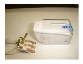
O3 Dans le trou coller un tube de laiton de 2/3mm, longueur 30 mm. Couper le couvercle pour le passage. du tube.
