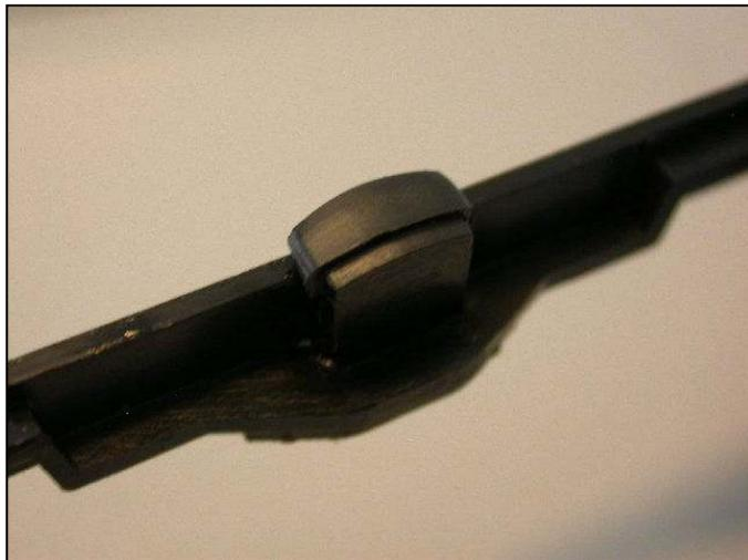
Découpons donc un de ces ergots sur un vieux boggie moteur déclassé (faut jamais rien jeter !) et collons-le sur le châssis afin d'assurer à ce dernier une position correcte. Le nouvel ergot devra dépasser de 3 millimètres le bas du châssis et sera positionné au milieu du boggie. Personnellement j'ai collé l'ergot avec de la colle contact. Mais il y a fort à parier qu'avec le temps celui-ci se décollera, n'hésitez donc pas à utiliser d'autres méthodes pour fixer
