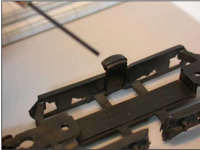
positionnement vertical de la caisse sur le boggie (excroissance de la caisse à positionner entre les deux portes balais). Sans le capot d'origine, le châssis pendouille lamentablement sur le boggie.
