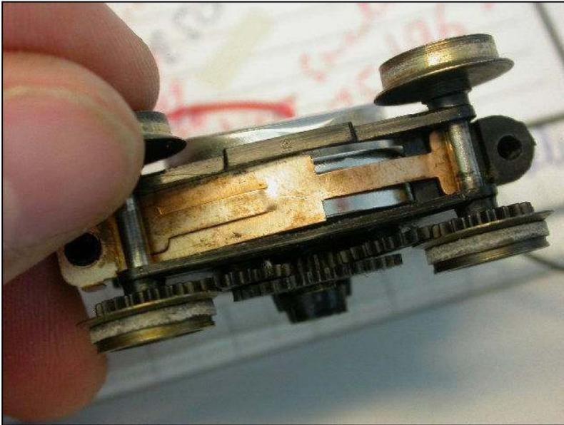
Remarquons que l'aimant permanent qu'il faut retirer sert ici également à maintenir le frotteur de prise de courant situé dans le boggie moteur. L'aimant est en fait constitué d'un anneau métallique et d'un ruban de « caoutchouc » aimanté. Ces deux pièces peuvent facilement être désolidarisées. Il faut donc remettre l'anneau métallique, sans l'aimant, à sa place afin d'assurer le maintien du frotteur.
